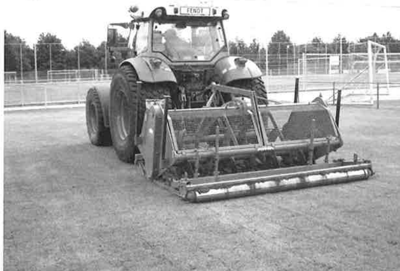
De schudfrees wordt gebruikt bij diepe verdichting van de bodem. De ondergrond wordt losgeschud.
